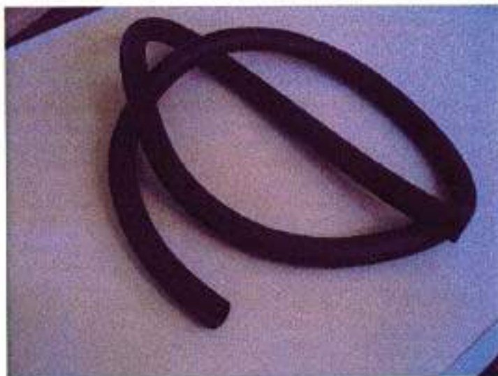
Εικόνα 1. Δείγμα δοκιμίου μέτρησης (θερμομονωτικό κέλυφος για κυκλικούς αγωγούς)
